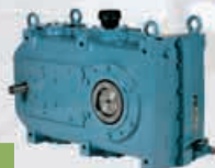
G-series Output torque max 100 kNm Gear ratio 6,3 - 630
